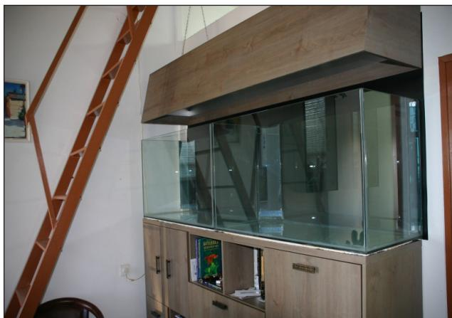
Аквариумы готовы. Размеры 110x50x60 (высота) см. Обратите внимание на задние углы. В них имеются вставки шириной 15 см, вклеенные герметично по длине, и не доходящие до дна и верхнего края аквариума на 1 см. То есть мы получили треугольный отсек, открытый снизу и сверху. Это и есть конструктивная особенность моего биофильтра. Можно эти вставки заказать из притемнённого стекла, тогда все трубы и необходимое дополнительное оборудование будут надёжно скрыты.
